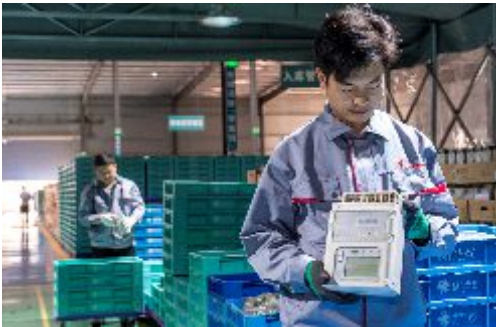
对回收电能表进行分类处置
